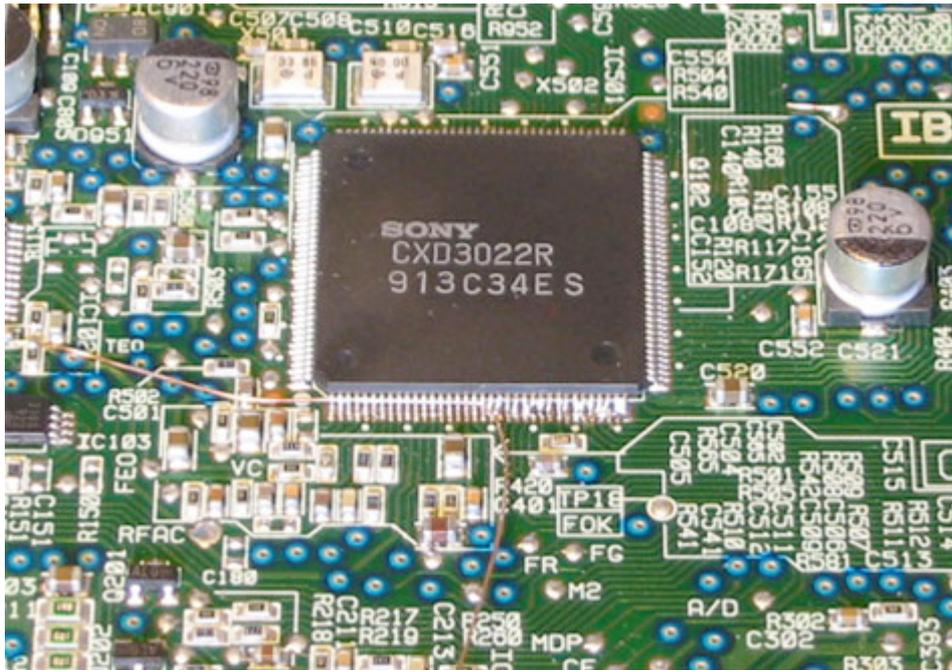
Y repetimos este procedimiento en los cuatro lados del integrado. Asegurarse que se calientan los pines bajo los cuales va a pasar el hilo de cobre para separarlos de los pads y hacerlo con mucho cuidado, sin forzar, sino... 😞
